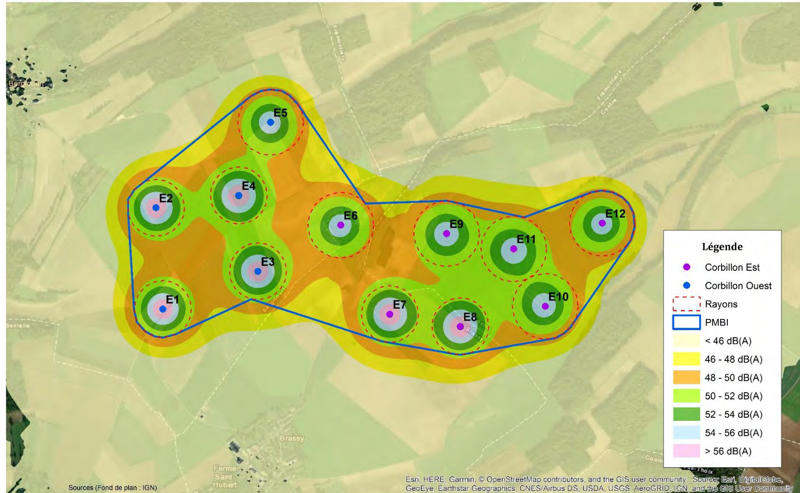
Niveaux sonores dans le périmètre de mesure de bruit de l'installation – Configuration Vestas en mode de fonctionnement normal pour un vent de vitesse standardisée de 10 m/s
