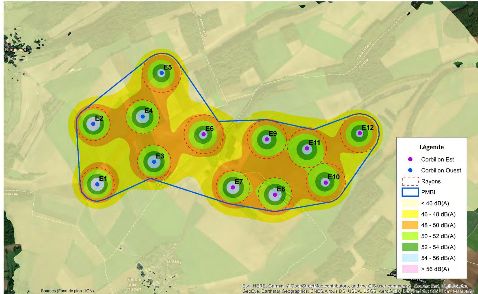
Niveaux sonores dans le périmètre de mesure de bruit de l'installation – Configuration Siemens Gamesa en mode de fonctionnement normal pour un vent de vitesse standardisée de 10 m/s
