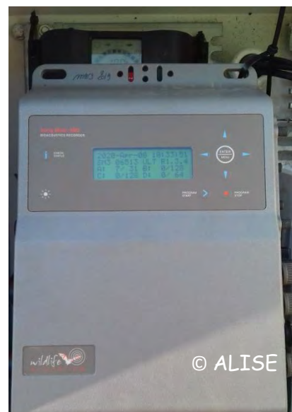
Photo 4 : Boîtier SM3BAT+ pour l'écoute passive en hauteur
