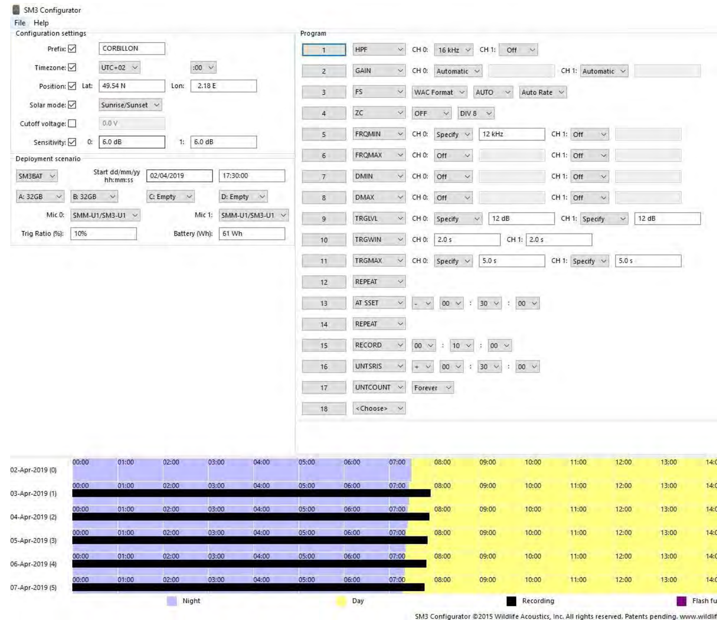
Figure 11 : Programmation du SM3BAT+ du mât carbone sur le logiciel SM3 Configurator de Wildlife Acoustics®
